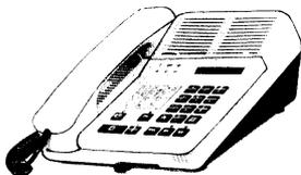
Výpravčí může komunikovat s vlakem v dosahu své základnové radiostanice, tj. v rozsahu obsluhované železniční stanice. V případě, že bliká **SÍŤ OBS.** - je v hovoru **dispečer**. Výpravčí potom může navazovat spojení jen pokud má stanovenou prioritu nebo v případě nouze. (Automaticky zruší hovor dispečera.) **Přednostně používat mikrotelefon.**
