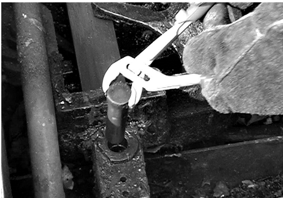
Vyjmutí spojovacího čepu
