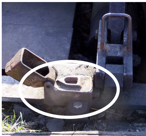
Samovratný přestavník (zapnutý do samovratné činnosti)
