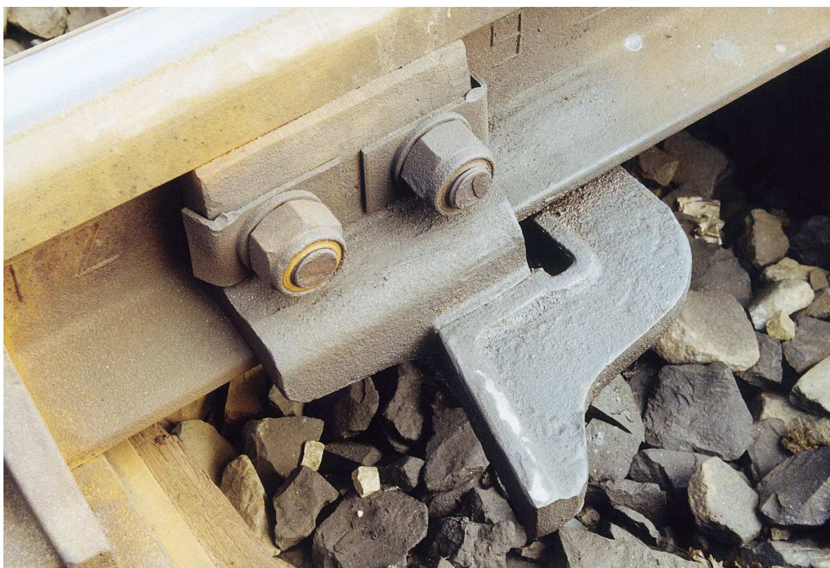
Hákový závěr – úplné zaklesnutí závěrového háku
