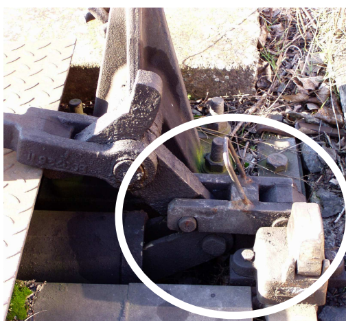
Samovratný přestavník (zapnutý do samovratné činnosti)
