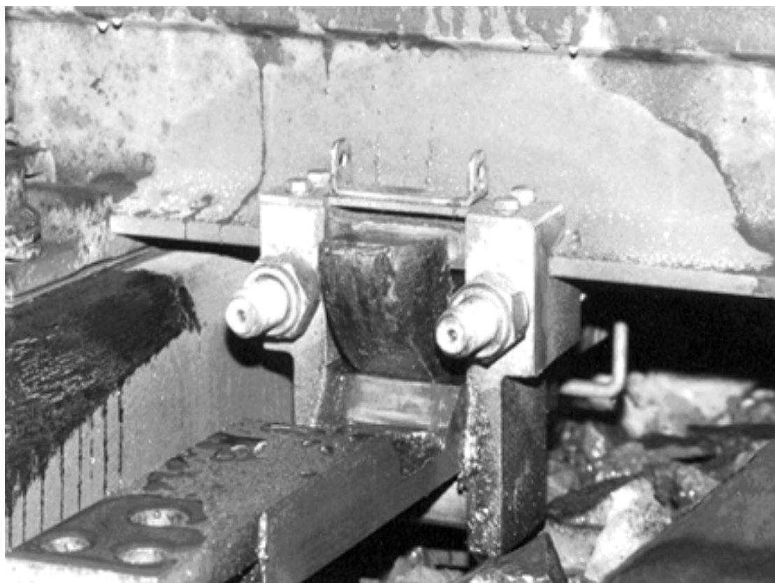
Čelistový závěr - nominální podepření závěrového háku
