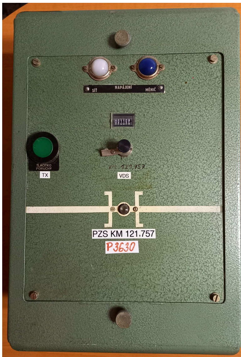
obrázek 409 – Ovládací skříňka PZS typu VÚD se základními prvky
