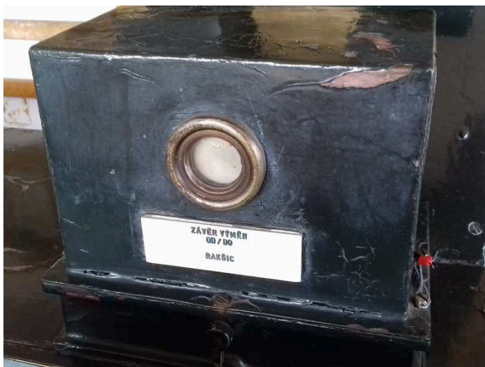
obrázek 333 – Samočinný závěr výměn (starší typ ČKD)
