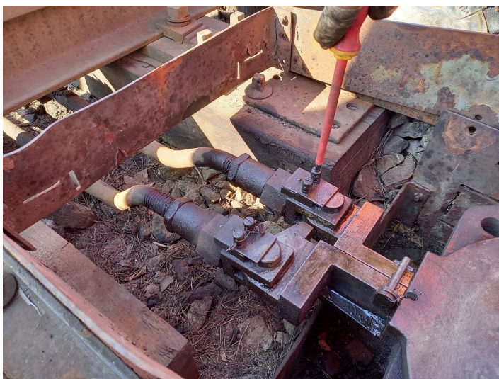
obrázek 189 – Vyšroubování šroubů pojistných plechů a sejmutí pojistných plechů
