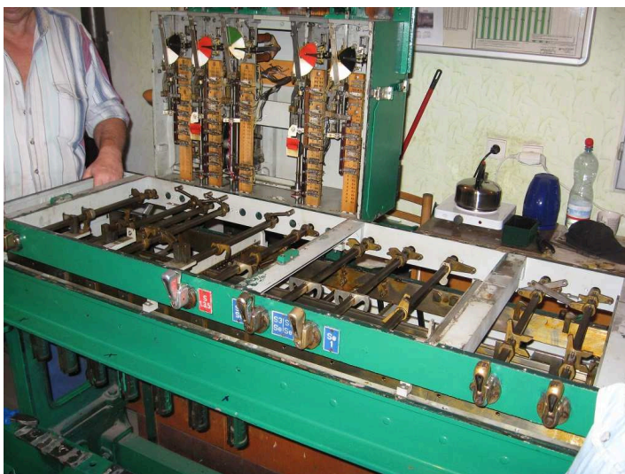
obrázek 256 – Nástavkový rám a pravítková skříň (bez krytu), se závislostními pravítky
