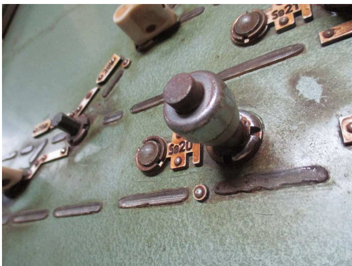
obrázek 14 – Sdružené návěstní tlačítko u makety seřadovacího návěstidla
