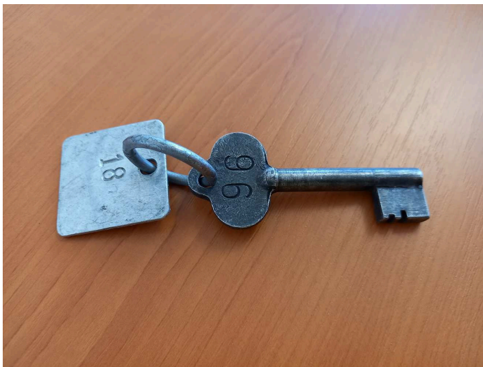
obrázek 100 – Hlavní klíč, nerozebíratelný spoj a štítek (příklad typu klíče č. 96 od výměnového zámku na výhybce č. 18)
