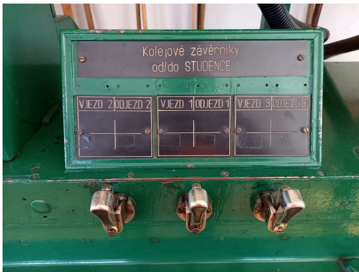
obrázek 292 – Samostatné směrové závěrníky pro každou dopravní kolej (řídící přístroj bez posuvných knoflíků a kolejového reliéfu)
