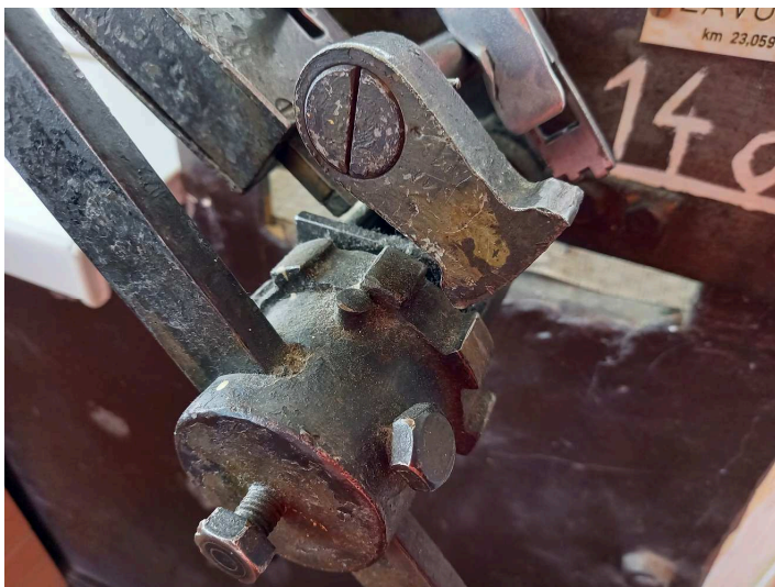
obrázek 401 – Západka proti zpětnému točení kliky
