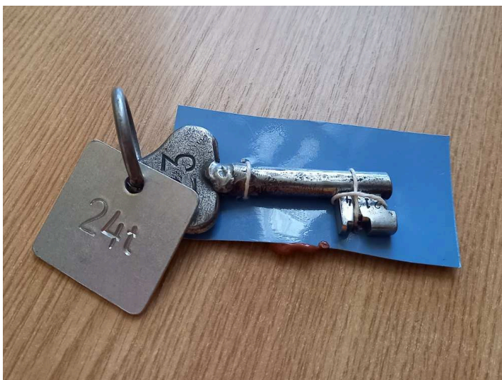
obrázek 101 – Náhradní klíč, nerozebíratelný spoj a štítek (příklad typu klíče č. 23 od odtlačného zámku na výhybce č. 24)
