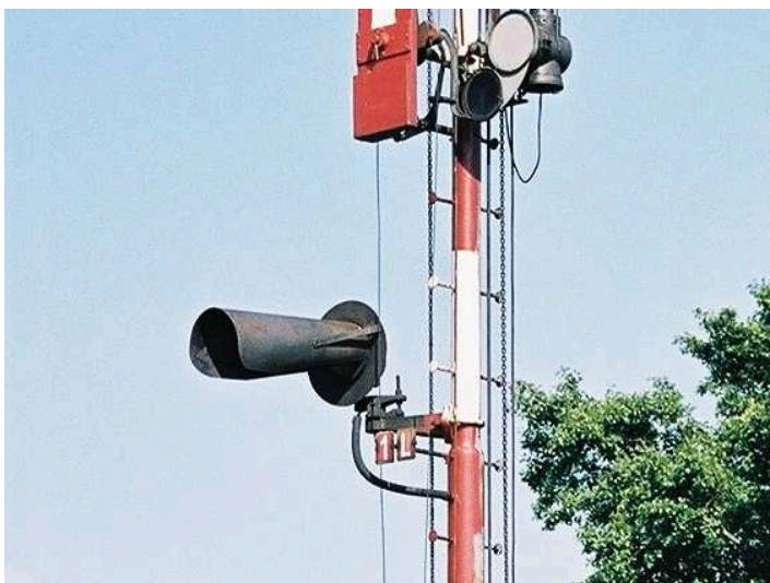
obrázek 202 – Přivolávací návěstidlo mechanického návěstidla (novější typ s jedním světlem)
