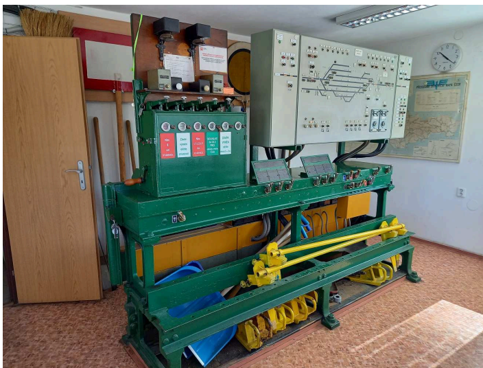
obrázek 241 – Řídící výhybkářský přístroj (doplňný indikační deskou)
