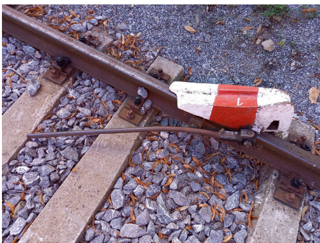
obrázek 86 – Výkolejka levá (starší typ)
