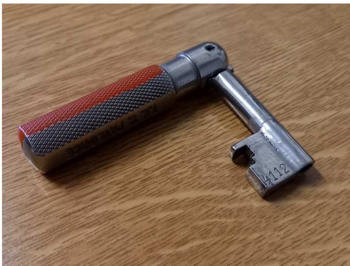
obrázek 25 – Traťový klíč vyjmutý z elektrického zámku
