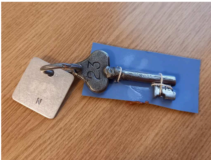
obrázek 102 – Náhradní klíč, nerozebíratelný spoj a zadní strana štítku (příklad typu klíče č. 23 od odtlačného zámku na výhybce č. 24)
