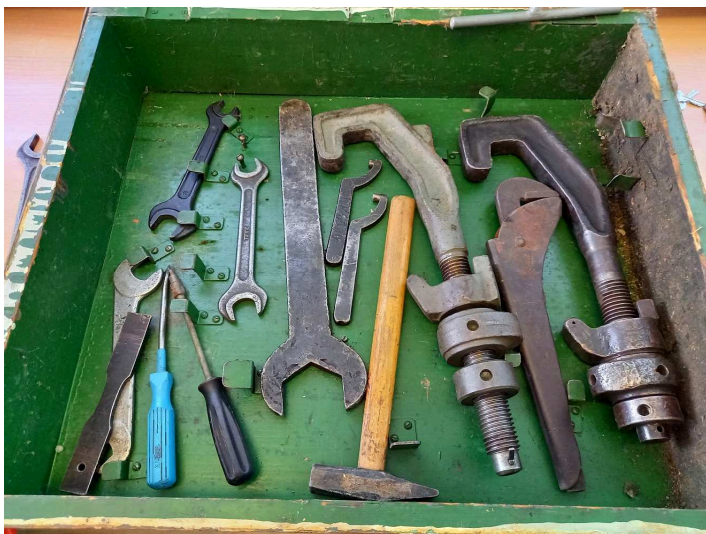
obrázek 193 – Bedna s nářadím na stavědle pro vypnutí výhybky (výkolejky) z ústředního přestavování nebo závorování
