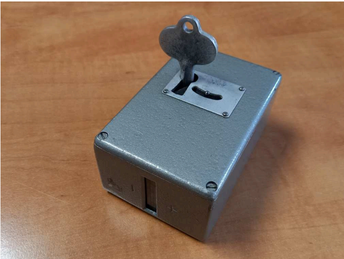
obrázek 449 – Pomocný přístroj na zkoušení hlavních a náhradních klíčů
