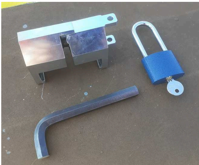
obrázek 124 – Přenosný závěrový zámek (přenosný zámek čelistového závěru, dále jen „PZČZ“), INBUS klíč a visací zámek pro uzamknutí PZČZ
