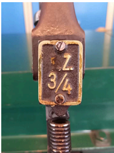
obrázek 264 – Příklad označovacího štítku závoříkové stavěcí páky
