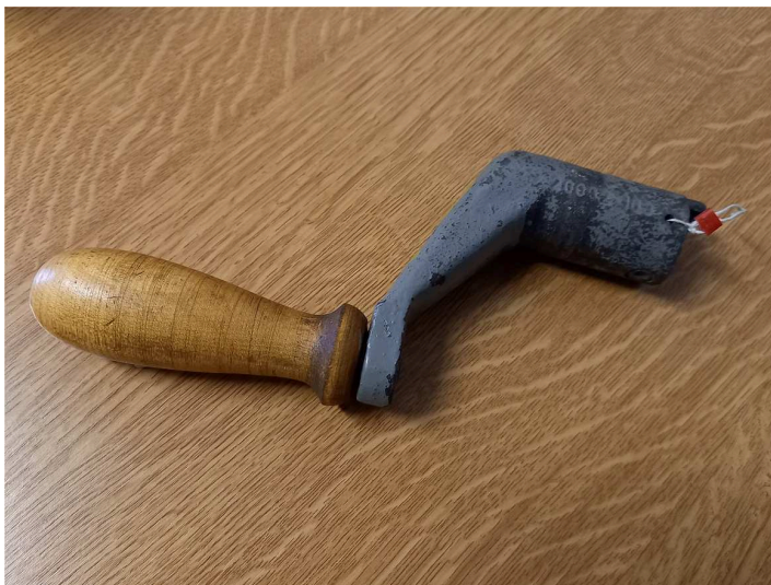
obrázek 26 – Klička pro přestavování výhybky (výkolejky) s elektrickým přestavníkem (nouzově ručním způsobem)
