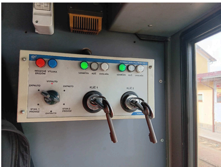
obrázek 448 – Radioblokové klíče uzamknuté v radioblokovém terminálu vozidla
