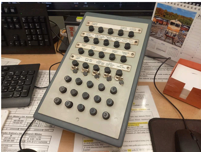
obrázek 348 – Ovládací skříňka (manipulátor) RZZ s číslicovou volbou
