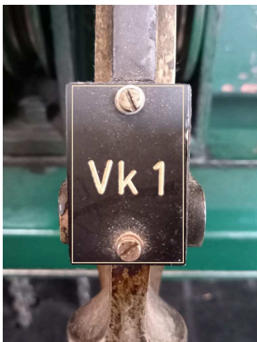
obrázek 263 – Příklad označovacího štítku výkolejkové stavěcí páky
