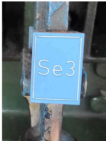
obrázek 266 – Příklad označovacího štítku návěstní stavěcí páky (seř. návěstidlo)
