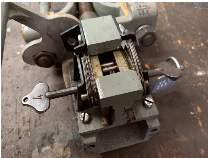
obrázek 105 – Detail demontovaného kontrolního výměnového zámku se sundaným krytem
