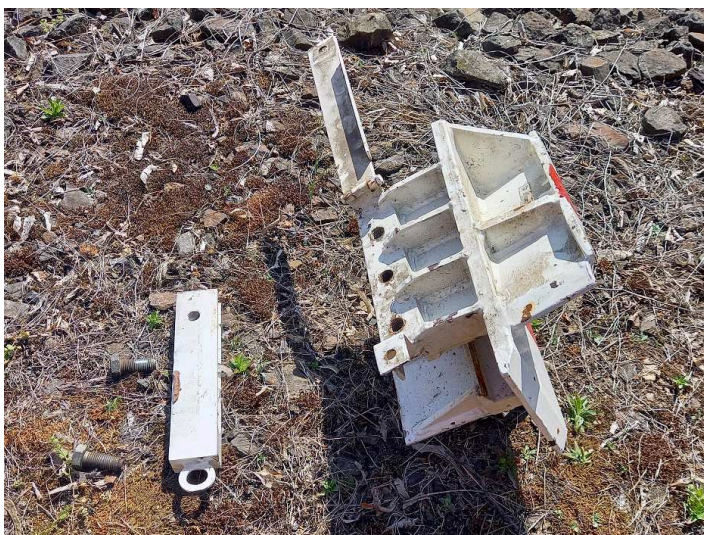
obrázek 92 – Přenosná výkolejka (součásti)
