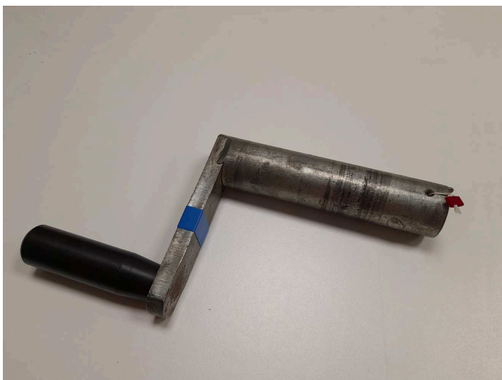
obrázek 27 – Klička pro přestavování výhybky (výkolejky) s hydraulickým přestavníkem (nouzově ručním způsobem)
