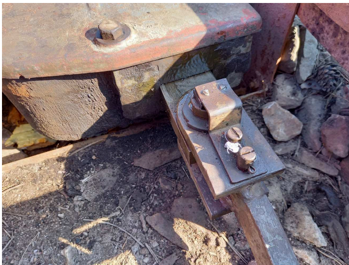
obrázek 165 – Spojení přestavné spojnice a přestavné tyče před vypnutím výhybky z ústředního přestavování
