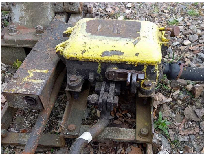
obrázek 150 – Elektrický výměnový zámek s kontrolou polohy, závorovací páčka v poloze, kdy výhybku nelze přestavovat (páčku lze uzamknout visacím zámkem)
