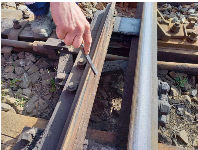
obrázek 83 – Západková zkouška – přiložení zkušební měrky na odlehlý jazyk
