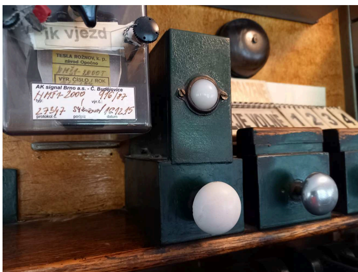
obrázek 312 – Tlačítko pro obsluhu přivolávací návěsti na výhybkářském přístroji
