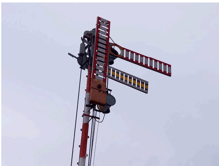
obrázek 200 – Detail horní části mechanického hlavního návěstidla dvouramenného, doplněného nepohyblivým ramenem
