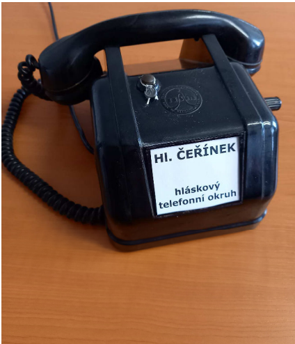
obrázek 380 – Telefonní přístroj MB pro hláskový telefonní okruh, s tlačítkem pro nouzové udělení telefonické odhlášky
