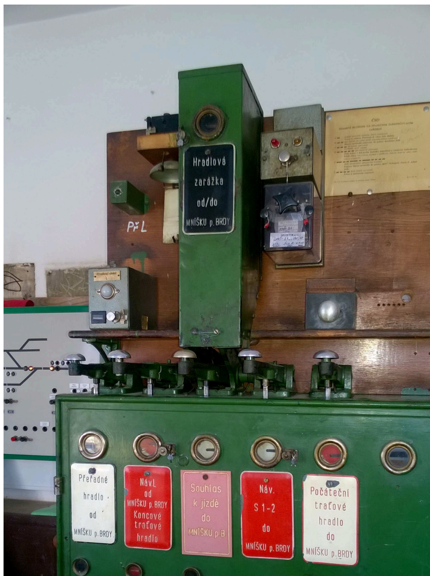
obrázek 297 – Příklad nadstavného hradlového závěru nad příslušným spolupracujícím hradlovým závěrem
