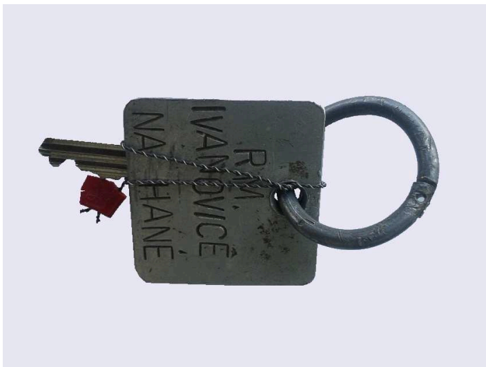
obrázek 30 – Náhradní klíče od stavědlové ústředny (plomba na drátu)
