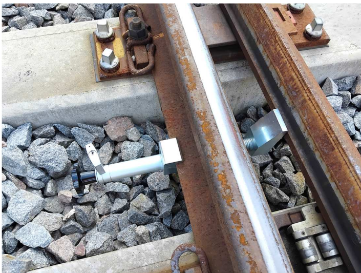
obrázek 142J – Příklad uzamknutí výhybky při osazení přenosného odtlačného zámku ve druhém mezipražcovém poli
