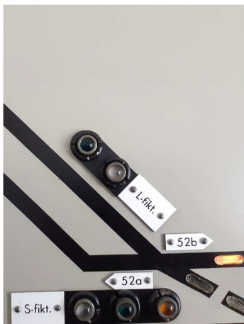
obrázek 23A – Příklad indikace (maketa) fiktivního hlavního návěstidla na indikační desce
