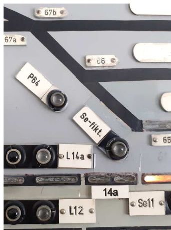
obrázek 23B – Příklad indikace (maketa) fiktivního seřadovacího návěstidla na indikační desce
