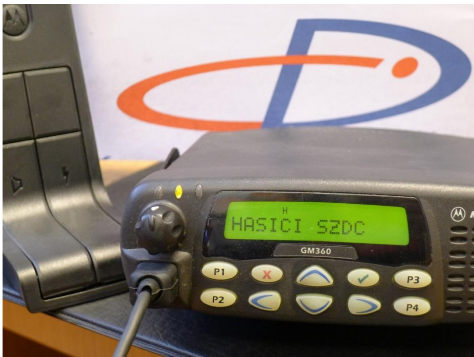
Obr. 2: Radiostanice GM360 při příjmu selektivní volby odeslané z radiostanice HSZ SZDC
