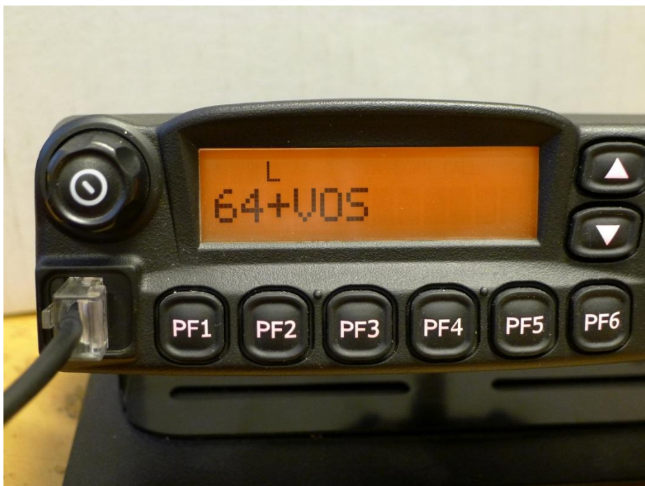
Obr. 4: Radiostanice TM-800 se zvoleným „přechodným“ kanálem VOS (označeným 64+VOS) – 64 je číslo kanálu, + (plus) označuje nový kanál, VOS je označení rádiové sítě
