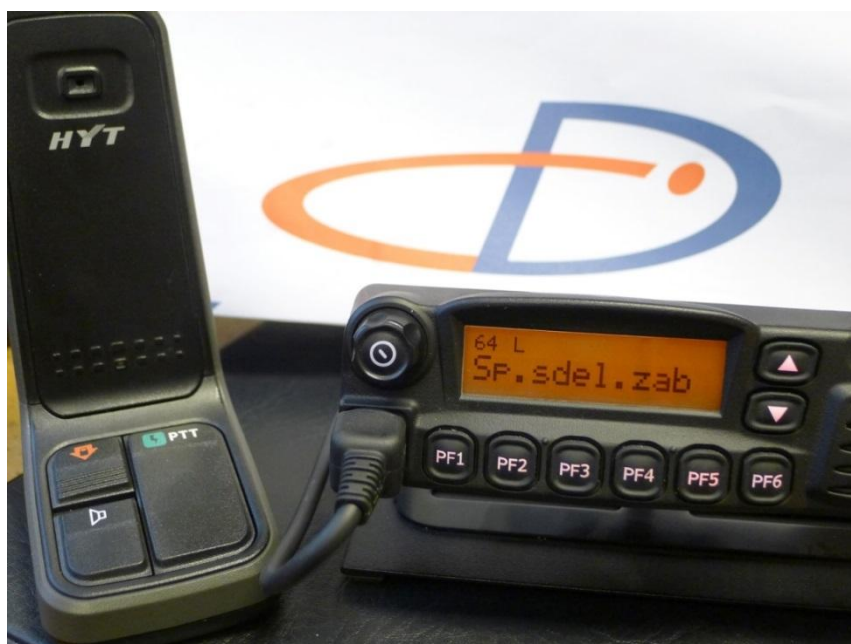
Obr. 5: Radiostanice TM-800 při příjmu selektivní volby odeslané z radiostanice Správy sdělovacího a zabezpečovacího zařízení
