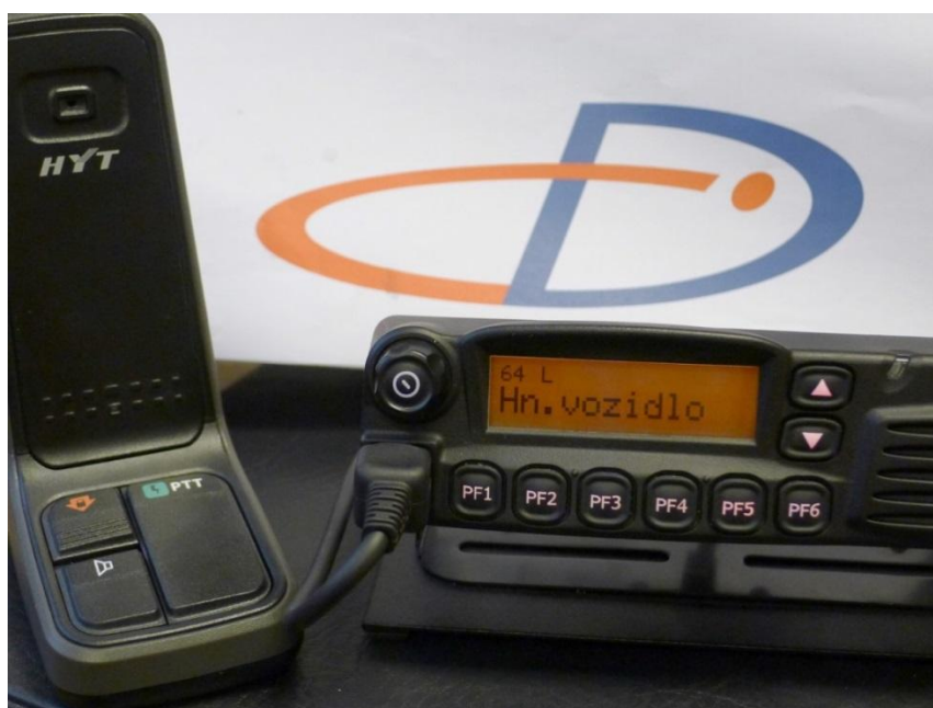
Obr. 6: Radiostanice TM-800 při příjmu selektivní volby odeslané z radiostanice hnacího vozidla
