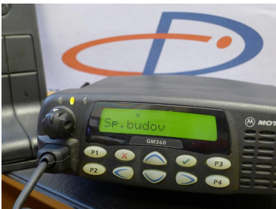
Obr. 3: Radiostanice GM360 při příjmu selektivní volby, odeslané z radiostanice Správy budov
