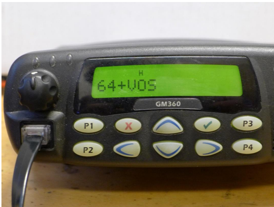
Obr. 1: Radiostanice GM360 se zvoleným „přechodným“ kanálem VOS (označeným 64+VOS) – 64 je číslo kanálu, + (plus) označuje nový kanál, VOS je označení rádiové sítě
