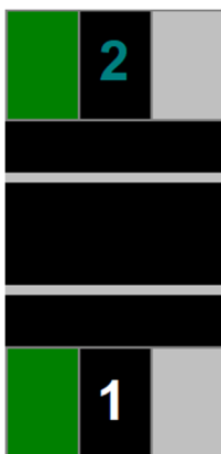
Obrázek A.196 – Pohotovostní stav všech PZS, na některém z PZS je výstraha (pro otevření není vyžadován povel ZUZ), v 1.TK na některém PZS anulace, v 2.TK na všech PZS bezanulační stav, PZM 2U v základním stavu
