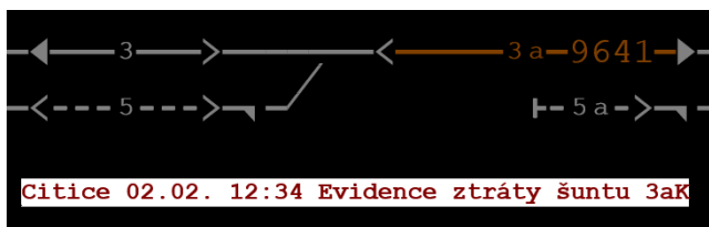
Obrázek 201 – Příklad indikace vzniku EZŠ na staniční koleji (s číslem vlaku)
