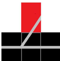
Obrázek B.11 – Poloha výhybky není indikována, KÚ volný, neaktivovaná pomalá jízda v jedné větvi výhybky (na reliéfu HMI)
