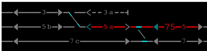
Obrázek 205 – Příklad stavu po postavení nouzových posunových cest pro předpokládaný směr jízdy vlaku
