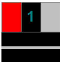
Obrázek A.198 – Poruchový stav některého z PZS jednokolejné trati, výstraha na některém z PZS (pro otevření není vyžadován povel ZUZ), na všech PZS bezanulační stav, PZM 2U otevřeno, klíč vyjmut z EMZ nebo porucha celistvosti
