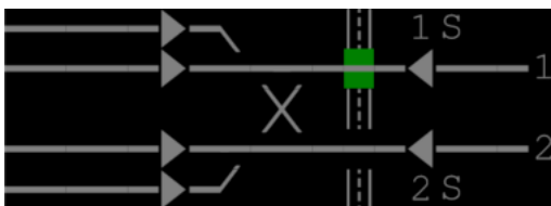
Obrázek 142 – Příklad předběžného uzavření přejezdu
