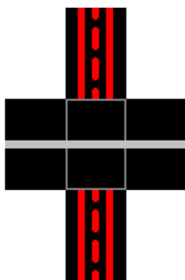
Obrázek A.180 – Poruchový stav PZS nebo VZPK, přejezd nebo přechod kolejí uzavřen
