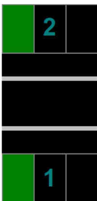
Obrázek A.195 – Pohotovostní stav všech PZS na dvoukolejné trati, na žádném PZS není výstraha, v obou kolejích všechna PZS v bezanulačním stavu, PZM 2U v základním stavu
