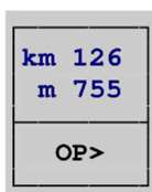
Obrázek 170 – Příklad menu přejezdu na reliéfu HMI před zavedením jízdy se zvýšenou opatrností
