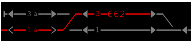
Obrázek 100 – Příklad vložení čísla vlaku, pro vlak, který stojí na (přes) více staničních kolejích
