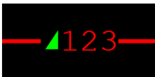
Obrázek B.48 – Zobrazení čísla vlaku a symbolu komunikujícího vlaku na sloučeném reliéfu JOP (na staniční koleji), mobilní část je v módu FS, aktivní kabina ve směru doleva, staniční kolej je obsazená vlakem
