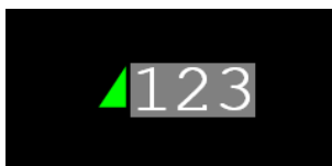
Obrázek B.53 – Zobrazení čísla vlaku a symbolu komunikujícího vlaku na sloučeném reliéfu JOP (v zásobníku nespárovaných vlaků), mobilní část je v módu FS, aktivní kabina ve směru doleva
