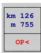
Obrázek 171 - Příklad menu přejezdu na reliéfu HMI po zavedení jízdy se zvýšenou opatrností
