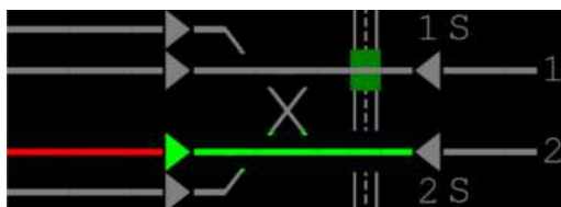
Obrázek 145 – Příklad předběžného uzavření přejezdu
