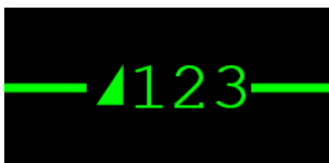
Obrázek B.50 – Zobrazení čísla vlaku a symbolu komunikujícího vlaku na sloučeném reliéfu JOP (na staniční koleji), mobilní část je v módu FS, aktivní kabina ve směru doleva
