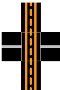
Obrázek B.80 – Pohotovostní stav PZS nebo VZPK, je zavedena jízda se zvýšenou opatrností
