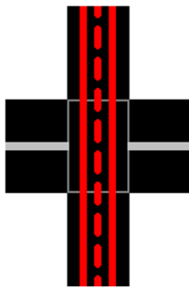
Obrázek A.179 – Poruchový stav PZS nebo VZPK, přejezd nebo přechod kolejí otevřen, PZM 2U otevřeno, klíč vyjmut z EMZ nebo porucha celistvosti
