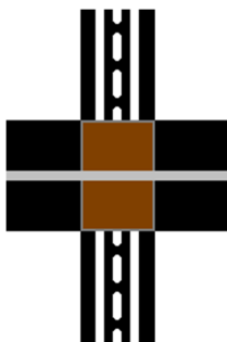
Obrázek A.183 – Pohotovostní stav PZS nebo VZPK, přejezd nebo přechod kolejí uzavřen, pro otevření přejezdu nebo přechodu kolejí je vyžadován povel ZUZ, výluka automatické činnosti nebo DKNP
