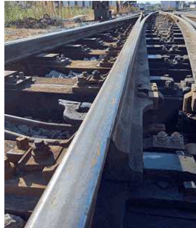
Jazyk křižovatkové výhybky přiléhající k opornici
