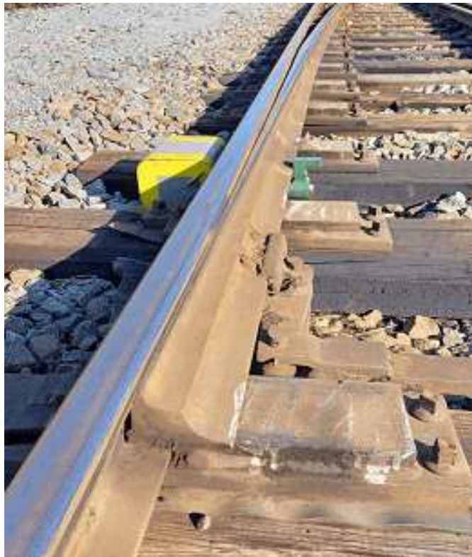
Jazyk jednoduché výhybky přiléhající k opornici
