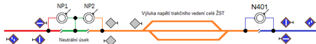
obrázek B.7 Výluka napětí trakčního vedení celé železniční stanice s neutrálním úsekem umístěným na záhlaví, který je krytý světelnými návěstidly pro elektrický provoz
