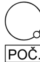
Tlačítko s počítadlem a uzávěrou proti náhodné obsluze, neplombované
