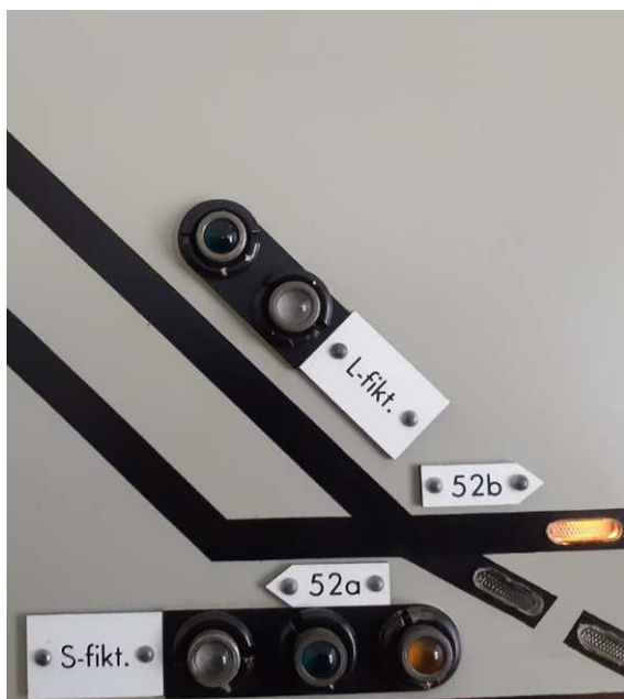
Příklad fiktivního hlavního návěstidla na indikační desce (SZZ RZZ)
