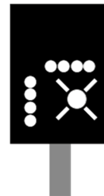
návěst „Hlavní návěstidlo dovolu je jízdu vlaku podle rozhledových poměrů “
