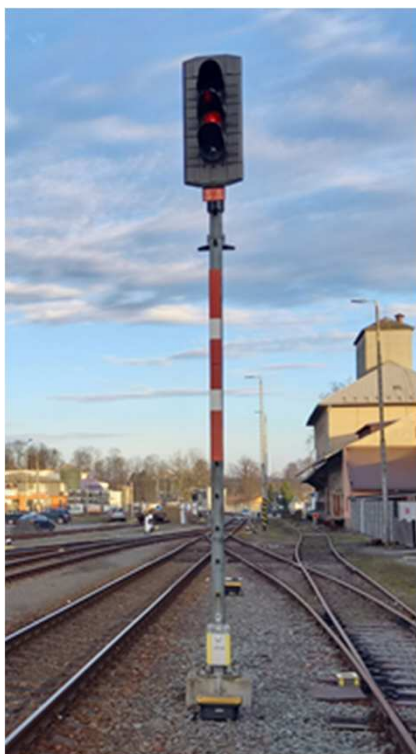
Stožárové návěstidlo umístěné na samostatném stožáru
