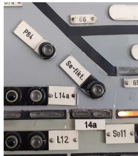
Příklad fiktivního seřadovacího návěstidla na indikační desce (SZZ RZZ)
