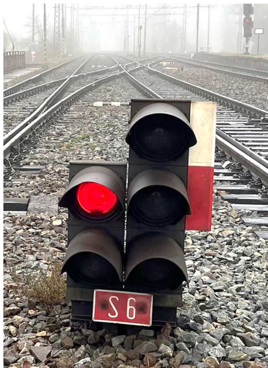
Trpasličí hlavní návěstidlo platné pouze pro vlaky (příklad s větší osovou vzdáleností)
