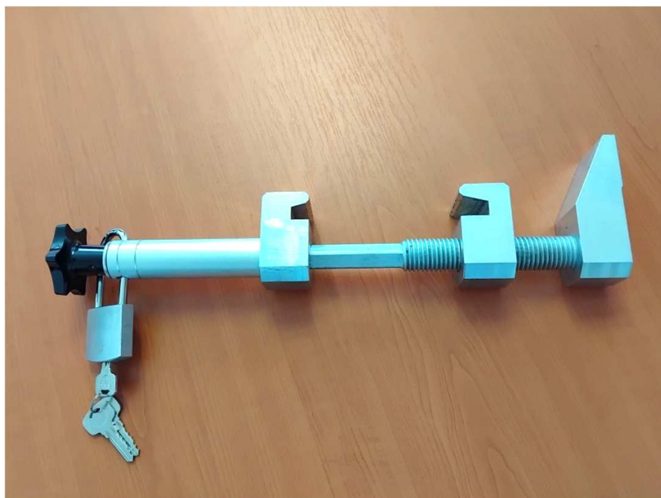
Přenosný odtlačný zámek
