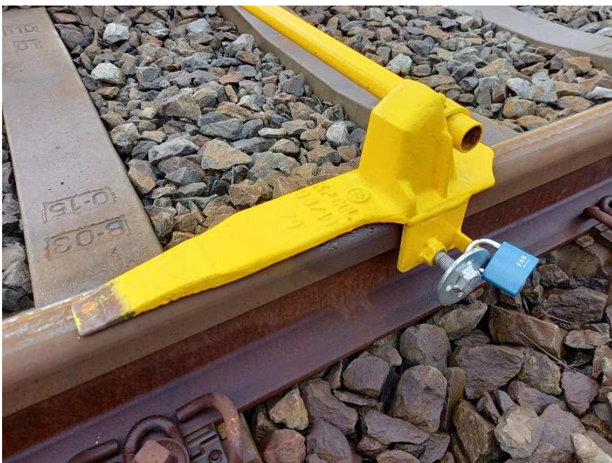
Stav KPU po zašroubování šroubu a uzamknutí visacím zámekem
