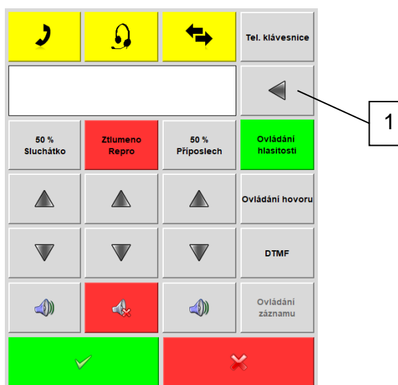
Obr. 2.9 - Panel ovládání hlasitosti
