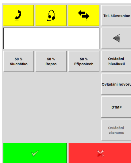
Obr. 2.8 - Panel ovládání telefonu a hlasitosti
