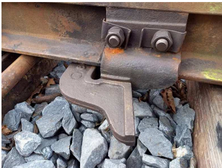
obrázek 3 – Úplné zaklesnutí závěrového háku u výhybky s hákovým závěrem jazyku
