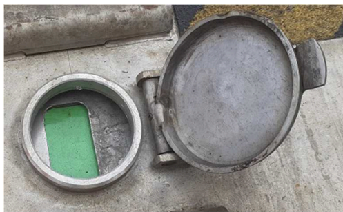
obrázek 11 – Uzavření vnitřního závěru v příslušné koncové poloze
