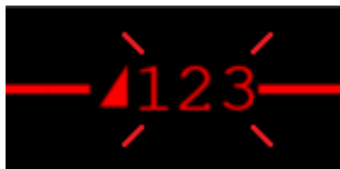
Obrázek B.54 – Zobrazení čísla vlaku a symbolu komunikujícího vlaku na sloučeném reliéfu JOP (na staniční koleji), mobilní část je v módu TR nebo PT, aktivní kabina ve směru doleva, vlak po vyslání adresného nebo generálního stop
