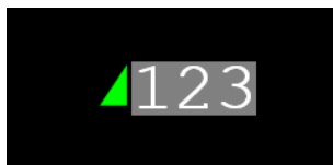
Obrázek B.53 – Zobrazení čísla vlaku a symbolu komunikujícího vlaku na sloučeném reliéfu JOP (v zásobníku nespárovaných vlaků), mobilní část je v módu FS nebo LS , aktivní kabina ve směru doleva
