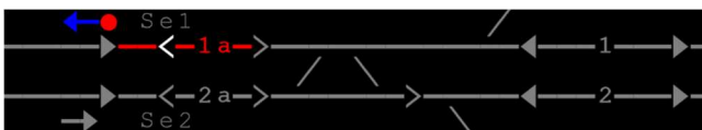
Obrázek C.47 – Indikace postavené posunové cesty (rozsvícení návěsti „Posun dovolen“ na světelném seřadovacím návěstidle ve funkci označnicku, včetně automatického zavedení zákazu odjezdu na trať)
