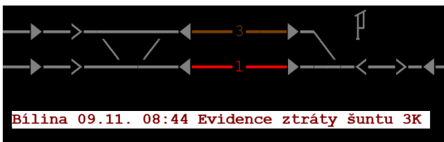
Obrázek 203 – Příklad indikace poruchového hlášení o EZŠ na staniční koleji po nouzovém převzetí PSt zpět na ústřední obsluhu
