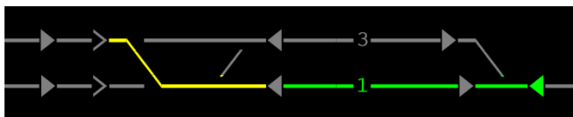
Obrázek 80 – Příklad vlakové cesty s prodlouženou ochrannou dráhou s vyznačenou oblastí ochranné dráhy
