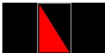
Obrázek B.43 – Mobilní část je v módu TR, PT, SF, IS, aktivní kabina ve směru doprava
