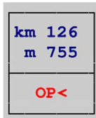
Obrázek 171 – Příklad menu přejezdu na reliéfu HMI po zavedení jízdy se zvýšenou opatrností
