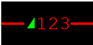
Obrázek B.48 – Zobrazení čísla vlaku a symbolu komunikujícího vlaku na sloučeném reliéfu JOP (na staniční koleji), mobilní část je v módu FS nebo LS , aktivní kabina ve směru doleva, staniční kolej je obsazená vlakem
