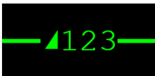
Obrázek B.50 – Zobrazení čísla vlaku a symbolu komunikujícího vlaku na sloučeném reliéfu JOP (na staniční koleji), mobilní část je v módu FS nebo LS , aktivní kabina ve směru doleva
