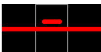
Obrázek A.46 – Výkolejka, svodný klín v koncové poloze mimo kolejnici, KÚ obsazen
