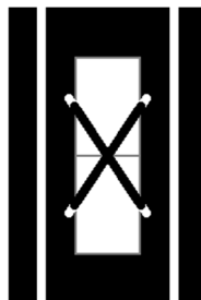
Obrázek 35 – Křižovatka s PHS, se ztrátou dohledu koncové polohy (svislé provedení) inverzní zobrazení
