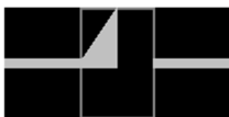
Obrázek A.43 – Výkolejka, svodný klín v koncové poloze na kolejnici, KÚ volný
