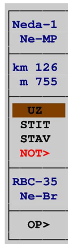
Obrázek 169 – Příklad podmenu přejezdu ze symbolu součtové hlásky PZZ na sloučeném reliéfu
