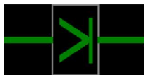
Obrázek B.61 – Vydáno oprávnění k jízdě pro mód FS za lokalizační značku
