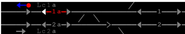
Obrázek C.50 – Indikace postavené posunové cesty (rozsvícení návěsti „Posun dovolen“ na světelném hlavním návěstidle ve funkci označnicku, včetně automatického zavedení zákazu odjezdu na trať)
