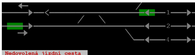
Obrázek C.51 – Příklad volby vlakové cesty, která není uvedena v ZT (například volba na nesprávnou kolej u jednosměrného TZZ), SZZ neumožňuje postavit vlakovou cestu na tuto kolej
