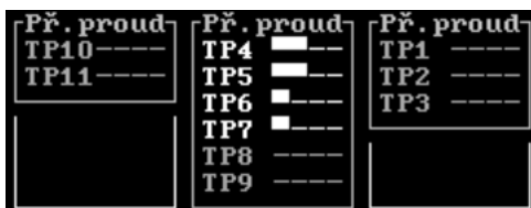
Obrázek 184 – Příklad indikace velikosti přestavného proudu ve větší dopravně, s 11 napájecími skupinami
