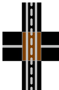
Obrázek B.77 – Pohotovostní stav PZS nebo VZPK, výluka přejezdu zavedena výluka automatické činnosti nebo DKNP, KÚ volný
