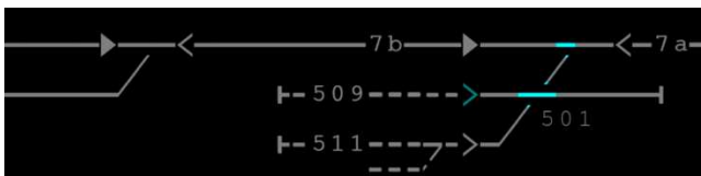
Obrázek C.58 – Indikace postavené nouzové posunové cesty
