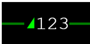
Obrázek B.51 – Zobrazení čísla vlaku a symbolu komunikujícího vlaku na reliéfu HMI (na staniční koleji), mobilní část je v módu FS nebo LS , aktivní kabina ve směru doleva, je vydáno oprávnění k jízdě v módu FS
