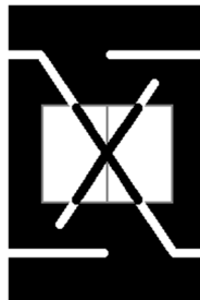
Obrázek 32 – Křižovatka s PHS, se ztrátou dohledu koncové polohy (vodorovné provedení), inverzní zobrazení
