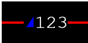
Obrázek B.49 – Zobrazení čísla vlaku a symbolu komunikujícího vlaku na reliéfu HMI (na staniční koleji), mobilní část je v módu SR, aktivní kabina ve směru doleva, staniční kolej je obsazená vlakem
