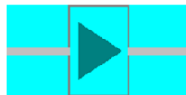
Obrázek A.91 – Návěstidlo na začátku nouzové jízdní cesty, volba nouzové jízdní cesty
