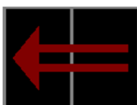
Obrázek B.73 – Traťový souhlas udělen, směr doleva, zavedena definitivní výluka ETCS na oblast traťové koleje
