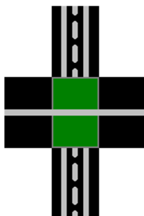
Obrázek A.184 – Pohotovostní stav PZS nebo VZPK, předběžné uzavření přejezdu nebo přechodu kolejí, pro otevření přejezdu nebo přechodu kolejí není vyžadován povel ZUZ
