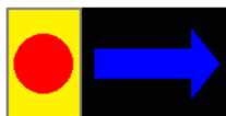
Obrázek B.88 – Porucha blokové podmínky RBC, zavedený zákaz odjezdu na trať, směr traťového souhlasu nelze měnit
