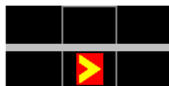
Obrázek B.84 – Balíková skupina, nominální směr doprava, chyba čtení balíkové skupiny, KÚ volný
