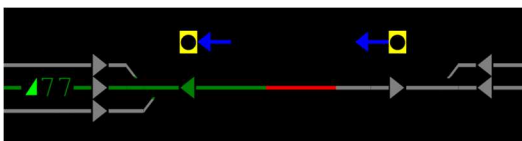
Obrázek 171A – Příklad indikace poruchy blokové podmínky RBC
