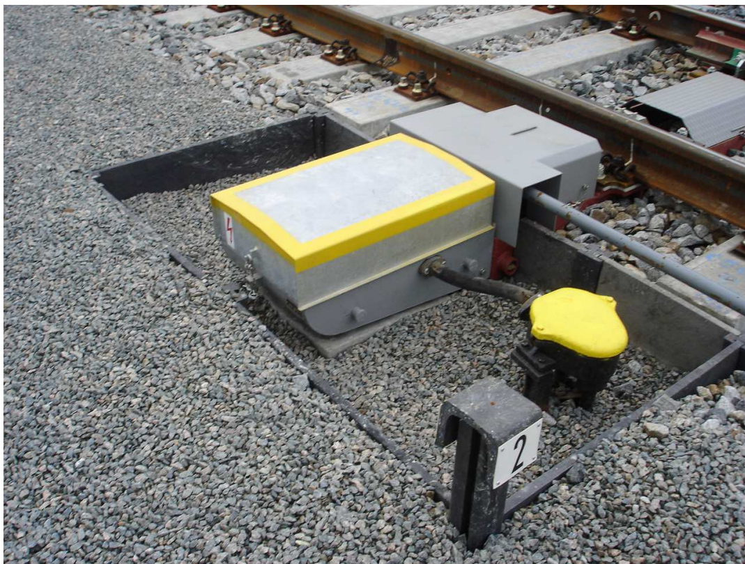
Přírubový žlabový pražec s přírubovým elektrickým přestavníkem
