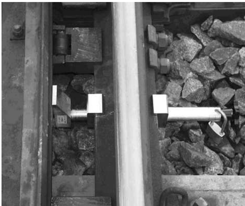
Přenosný odtlačný zámek v zajišťovací poloze
