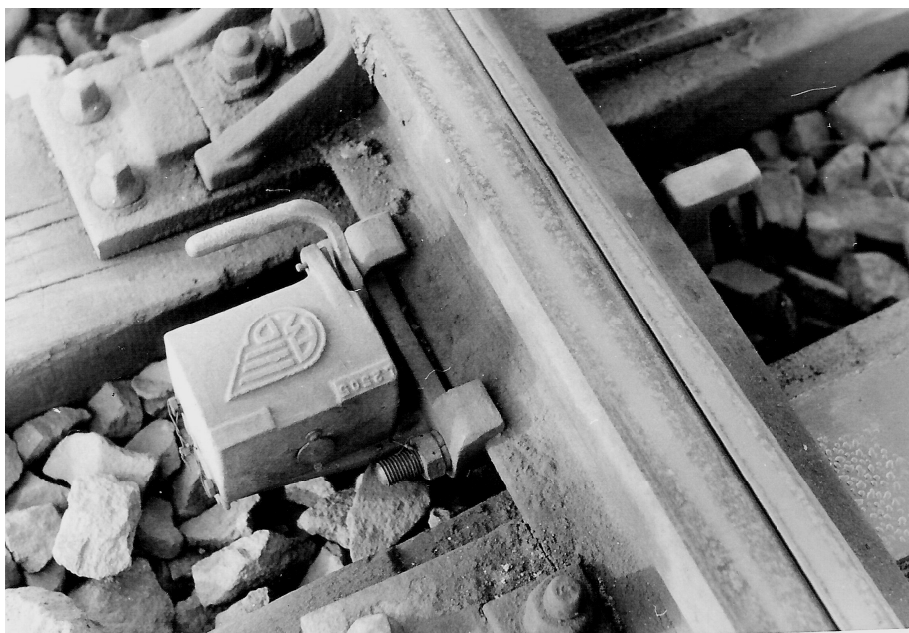
Uzamčený výměnový zámek bez ochranné skříňky
