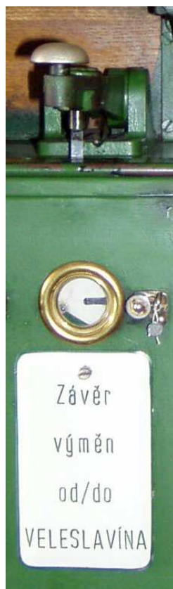
Výměnové hradlo s nouzovým vybavovacím zařízením
